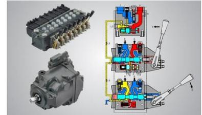
**Mit „Load sense“ Hydraulikpumpen ist der Kraftstoffverbrauch ca. 20-25 % geringer als mit herkömmlichen Hydraulikpumpensystemen.**
