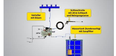
Staubniederschlagssystem mit Hochdruckpumpe
