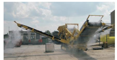
Staubniederschlagssystem mit Hochdruckpumpe
