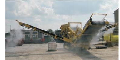
Staubniederschlagssystem mit Hochdruckpumpe
