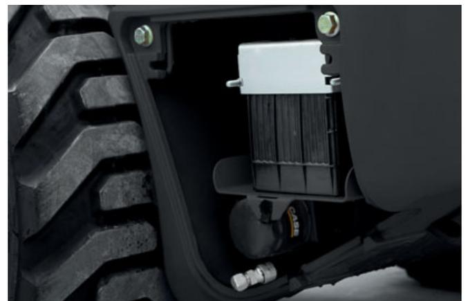
**Clevere Lösung:** der Zugang zu Batterie und Öl-ablassventilen
