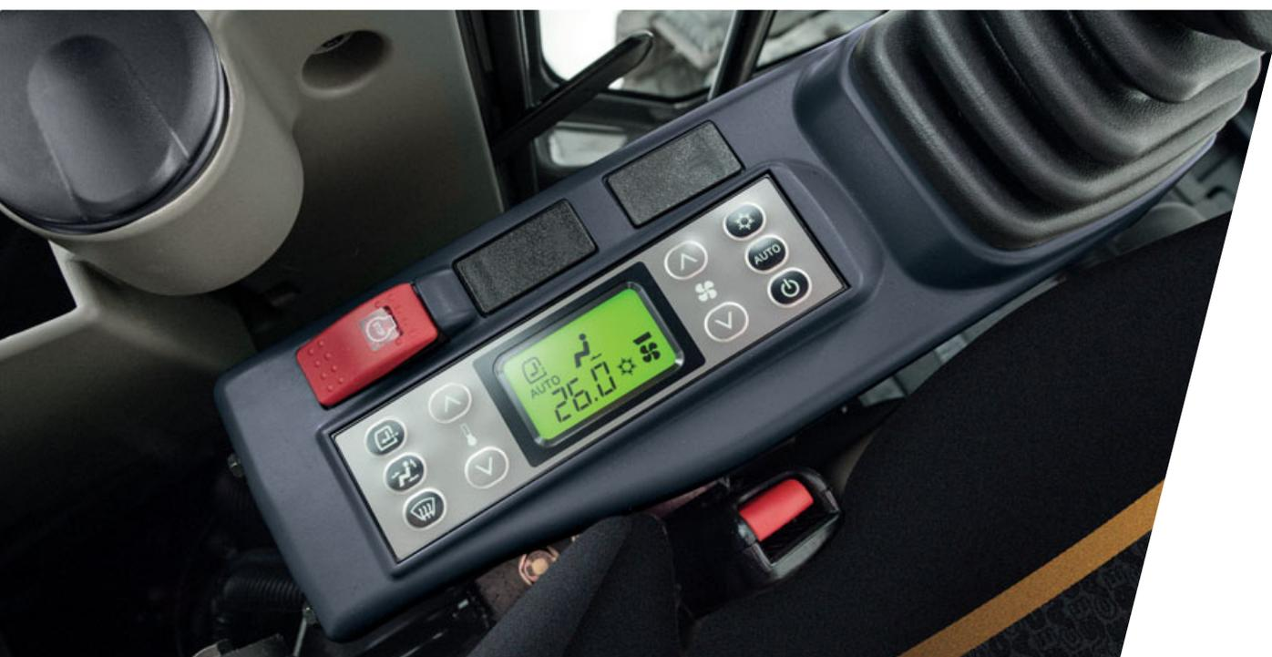
Climatizzatore automatico: eccellente controllo della climatizzazione cabina
