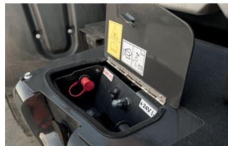
Interruttori per l'apertura del cofano e per l'accensione/spegnimento della batteria. Il cofano si apre anche se la batteria è scarica grazie alla predisposizione esterna per attaccare uno starter.
