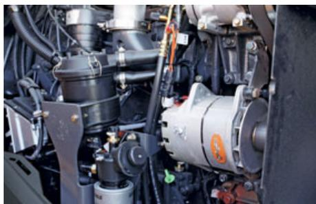
I punti di manutenzione del filtro del carburante e dell'olio motore sono facilmente accessibili da terra da entrambi i lati, mentre gli altri filtri si trovano dietro le scalette posteriori.
