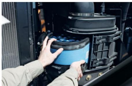
Il filtro dell'aria può essere rimosso facilmente e la polvere viene aspirata ed espulsa nello scarico.
