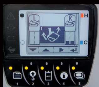
Regolazione del flusso dell'olio (SP1 e SP2)
