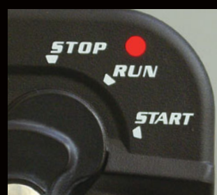
Antifurto immobilizzatore attivazione allarme LED
