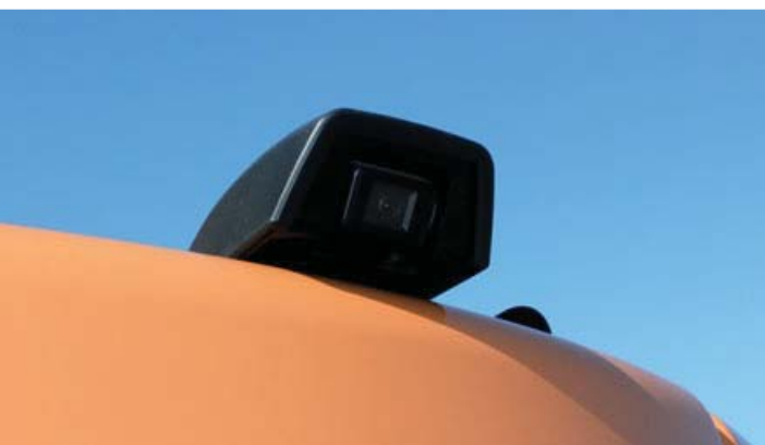
Telecamera posteriore: maggiore sicurezza sul luogo di lavoro
