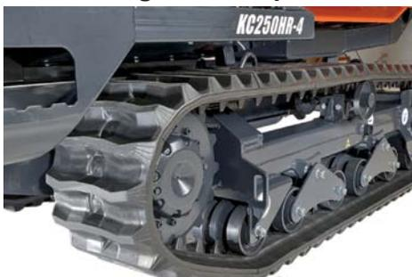
Il telaio inferiore del KC250-4 è dotato di rulli a triple flangia. Otto di loro sono montati su un supporto oscillante, offrono così un'ottima stabilità su pendii e terreni irregolari riducendo il rischio di scivolamento. I cingoli a passo corto riducono le vibrazioni, offrendo così il massimo confort all'operatore anche ad alta velocità.
