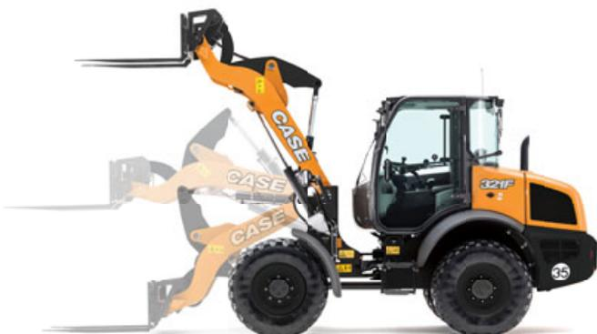
**Z-bar** è il tipo di attacco più versatile. Offre una forza di strappo superiore grazie ai 2 cilindri di sollevamento e a un'altezza di scarico superiore.
